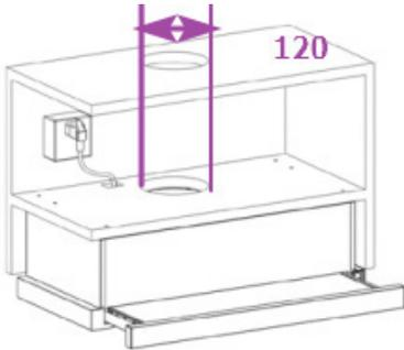
Просверлите 6 отверстий диаметром 4 мм в ящике для установки вытяжки. Убедитесь, что расстояние от края отверстия до края шкафа составляет не менее 35 мм.
