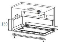
Используйте инструменты, чтобы затянуть винты и зафиксировать кухонную вытяжку в шкафу.
