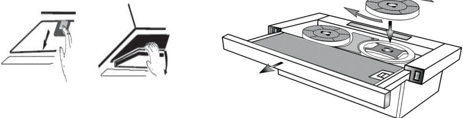
Установите угольный фильтр на моторе и поверните по часовой стрелке для закрепления. То же самое сделайте с другой стороны мотора.
