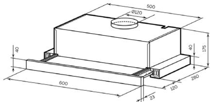
Убедитесь, что расстояние от края отверстия до края шкафа составляет не менее 35 мм. Наметьте 6 отверстий диаметром 4 мм. Просверлите отверстия для переходника и воздуховода. Установите переходник и антивозвратный клапан на выпускное отверстие вытяжки.
