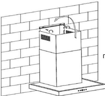
Просверлите **2 отверстия** по **8 мм**. Закрепите короб с помощью двух винтов.
