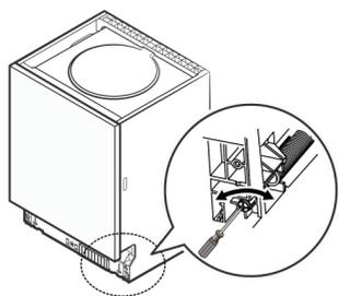
Правильным считается такое натяжение пружины, при котором открытая дверца остается горизонтальной в полностью открытом положении, но при это ее можно легко закрыть подтолкнув пальцем вверх.
