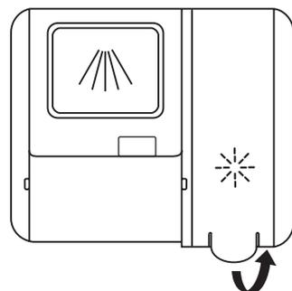
Снимите крышку бачка для ополаскивания, подняв ручку
