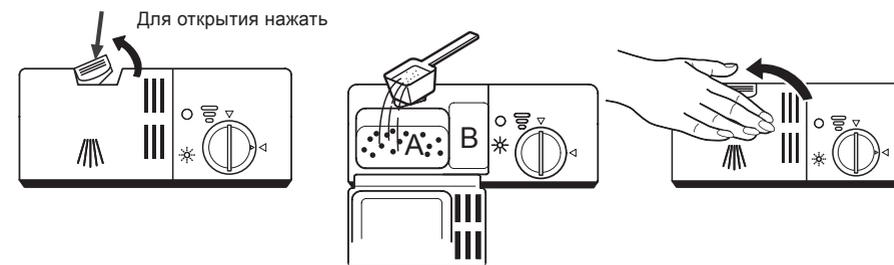
Для открытия крышки нажмите на фиксатор на дозаторе моющего средства
