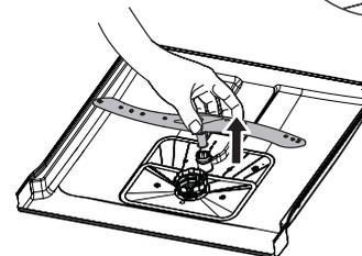
Чтобы снять держатель нижнего оросителя, вытяните ороситель вверх
