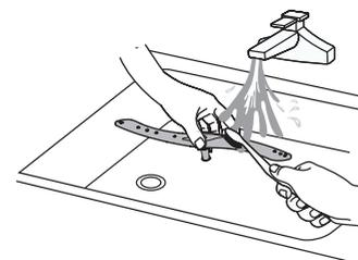
Вымойте держатели оросителей в мыльной и теплой воде и используйте мягкую щетку для очистки форсунок. Замените их после тщательной промывки
