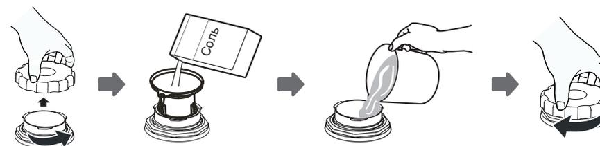
5. Сразу после засыпки соли в контейнер следует запустить программу промывки (например, использовать короткую программу). Если этого не сделать, система фильтров, насос или другие важные части машины могут быть повреждены соленой водой. Гарантия производителя не распространяется на такие поломки
