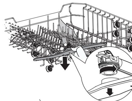
1. Чтобы снять держатель верхнего оросителя, удерживайте гайку в центре неподвижно и поверните распылитель против часовой стрелки, чтобы удалить его.
