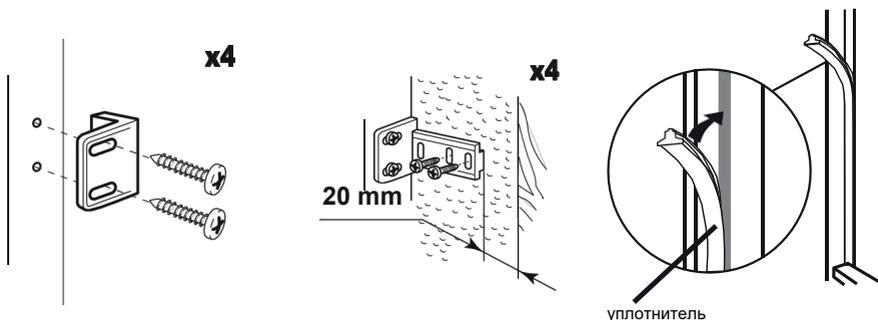
Установите ползунок в кронштейне и закрепите его на дверце мебельной панели на расстоянии **20-22 мм** от края панели, как показано на рисунке далее, убедившись, что ползунок расположен по центру и горизонтально внутри кронштейна. Надежно затяните вручную.
