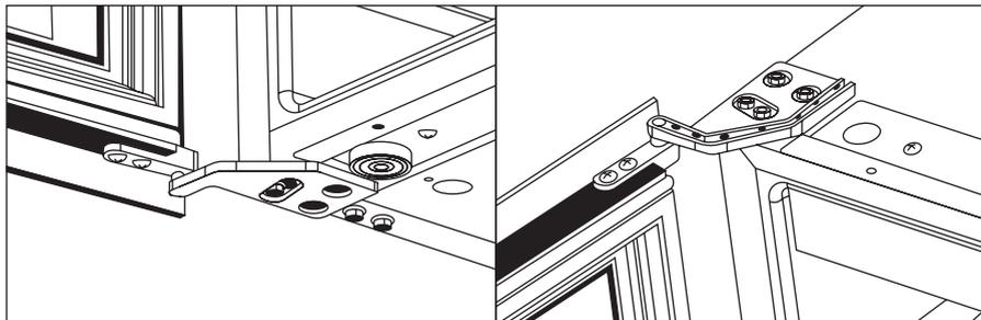
7. Установите правую нижнюю петлю на левый верхний угол устройства и закрепите ее винтами.
