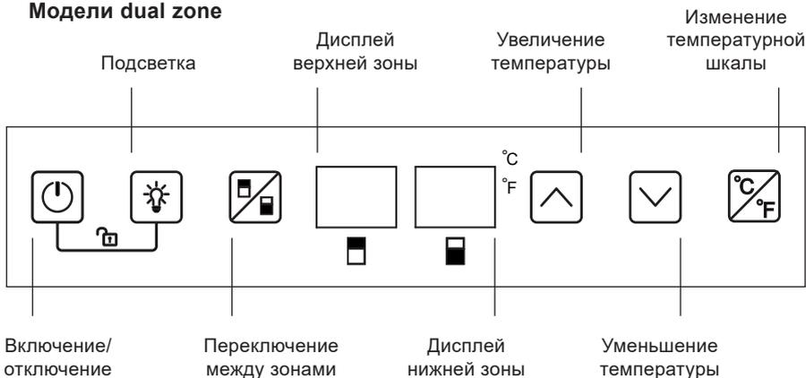
– Чтобы включить/отключить винный шкаф, коснитесь сенсора
