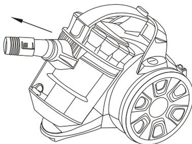
2. Установите удлинительную трубку на ручку, а саму трубку - на насадку, как показано на рисунке.
