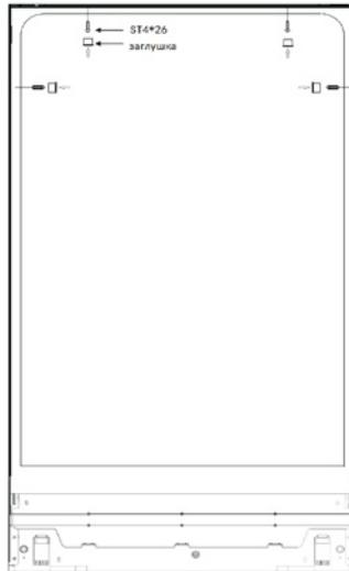
В обшивке посудомоечной машины с правой и левой стороны, а также сверху имеется 4 отверстия. Для крепления посудомоечной машины к кухонному модулю используйте деревянные винты ST4\*26 (соответствующие самонарезающие винты).
