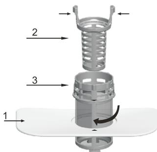
Фильтрующая система состоит из грубого фильтра, плоского (основного) фильтра и микрофильтра (тонкого фильтра).
