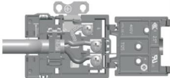
Для подключения к однофазной сети 220-240 В с заземлением: коричневый провод подсоединить к L, синий - к N, а провод заземления (желто-зеленый) – к
