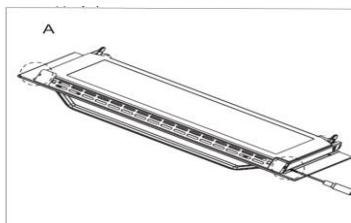
б. Снимите крепление и верхние накладки пластмассовой вентиляционной решетки.
