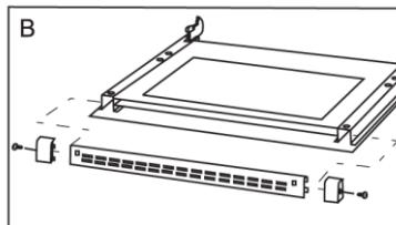
в. Выньте внутреннее стекло из крепления в нижней части дверцы. После очистки вставьте внутреннее стекло в пластмассовое крепление. Установите крепление обратно на дверцу и затяните его болтами
