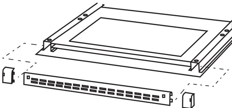
3. Выньте внутреннее стекло из крепления в нижней части дверцы. После очистки вставьте внутреннее стекло в пластмассовое крепление. Установите крепление обратно на дверцу и затяните его болтами.
