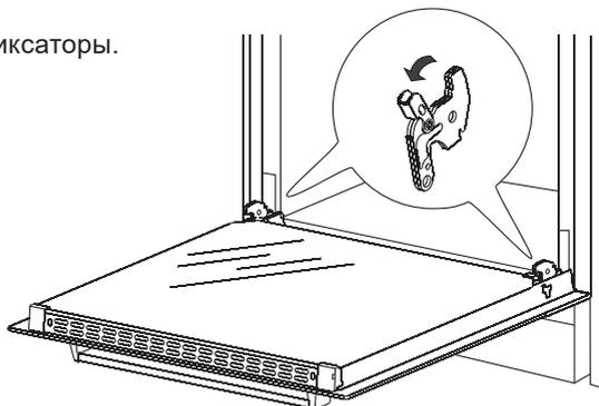
3. Осторожно закрывайте дверцу прибора, пока не услышите характерный звук сцепления. Придерживая дверцу обеими руками, прикройте ее еще немного и потяните вверх, чтобы извлечь болт петли из духового шкафа.
