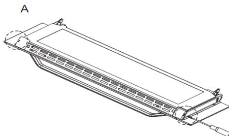
2. Снимите крепление и верхние накладки пластмассовой вентиляционной решетки.
