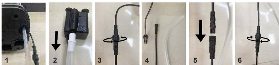
Если Вы обнаружили неисправность — насос не перекачивает воду в основной блок — разберите и соберите блок насоса, руководствуясь схемой, приведенной далее. Чтобы снять насос, поверните разъем против часовой стрелки, а чтобы установить его на место, поверните разъем по часовой стрелке.
