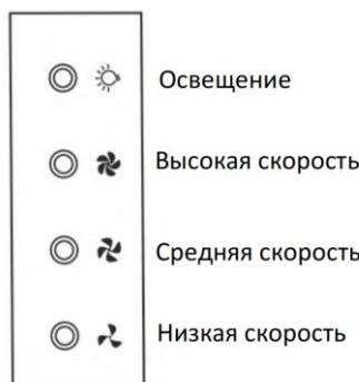
Высокая скорость – используется для устранения сильных паров, включая длительный период: возникающих во время жарки и основательного приготовления пищи, а также при необходимости экстренного проветривания помещения (например, при подгорании пищи). Нажмите кнопку «Высокая скорость», загорится внутренний индикатор, и двигатель начнет работу на высокой скорости. Нажмите данную кнопку еще раз, и двигатель перестанет работать.
